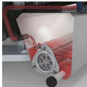
③ Das vorgewärmte Zulaufwasser wird in den Boiler geleitet und muss dadurch nicht mehr komplett aufgeheizt werden.
